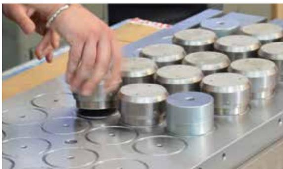
Die einteilige Konstruktionsweise von MILLTEC bildet zusammen mit den RMP-Polverlängerungen ein extrem leistungsfähiges Spannsystem für Werkstücke mit unterschiedlichen Höhen oder verformten Oberflächen. So ist ein verzugsfreies Spannen des Werkstücks auf einfache Weise möglich.
