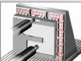
Planfräsen, Konturfräsen und Durchgangsbohrungen auf Maschinen mit horizontaler Spindelachse
