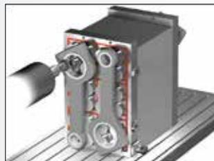
Bearbeitung komplexer Werkstücke auf Magnetspanntürmen
