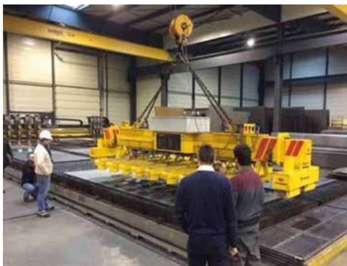
Sistema magnetico elettro-permanente serie COMBI per il carico/scarico macchine da taglio in un'unica operazione
