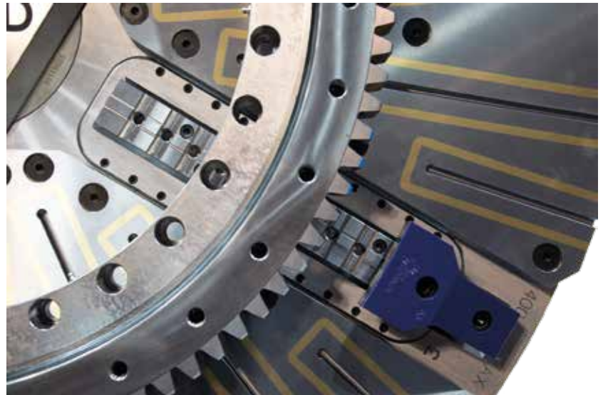
Soluzioni magnetiche ibride con sistema meccanico autocentrante SMW AUTOBLOK
