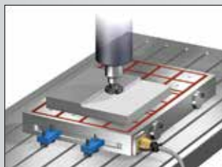
Spianatura su macchina con mandrino asse verticale
