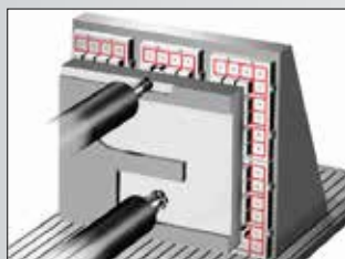
Spianatura, contornatura e foratura passante su macchina con mandrino asse orizzontale
